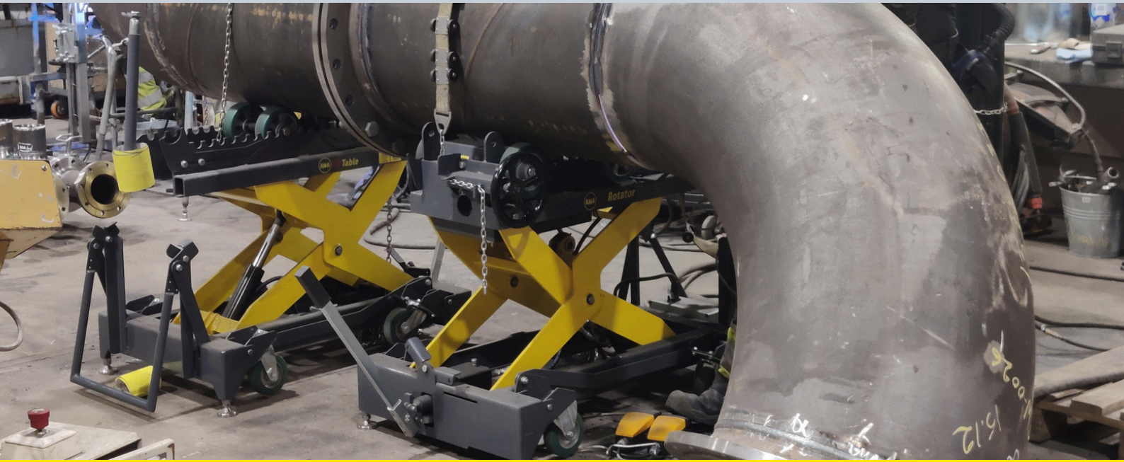
AMA® HD Rotator Maks. belastning 1500 kg Produktkode 6010
