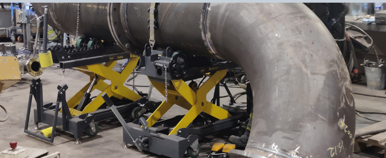
AMA® HD Rotator Udźwig 1500 kg Kod produktu 6010
